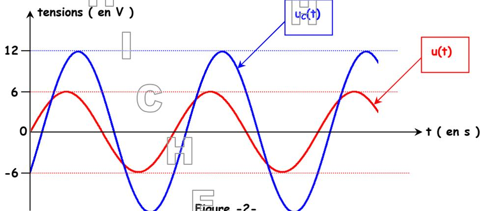
a) Montrer que la tension  $u(t)$  est en avance de  $\left(\frac{\pi}{6}\right)$  par rapport à la tension instantanée  $u_C(t)$  aux bornes du condensateur.
