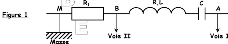
Pour une fréquence  $N_1$  de la tension d'alimentation, on obtient sur l'écran de l'oscilloscope les courbes (I) et (II) de la figure 2 :
