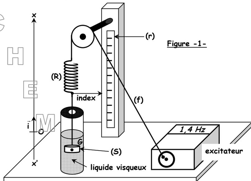
où  $h$  est une constante positive dont la valeur dépend de la nature du liquide visqueux utilisé et de la forme du solide et  $\vec{v}$  est la vitesse instantanée du centre d'inertie  $G$  de (S).
